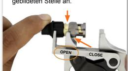
2. Lösen Sie mit dem Betätigen des Werkzeugs die Kappe vom Stecker.
